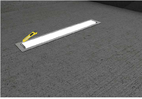
PH PRODRAIN Duş kanalı zemin izolasyonu / Apply waterproofing
